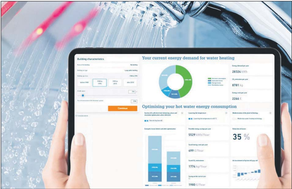
Hycleen Automation System programmeres til hvilken temperatur, vandet skal have, samt hvornår det skal skylles igennem for at sikre, at der ikke opstår legionella.
