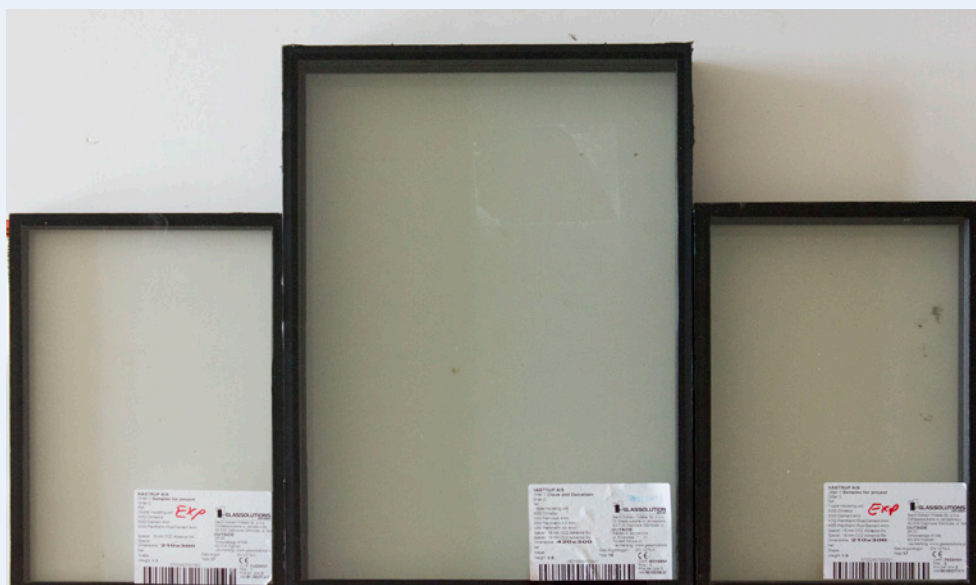
Fig 3. Rudetyper. 2-lags energirude med jernfattigt glas (tv) og 3-lags standard energirude (th) i midten 3-lags energirude med jernfattigt glas som supplerende reference i laboratiormålinger
