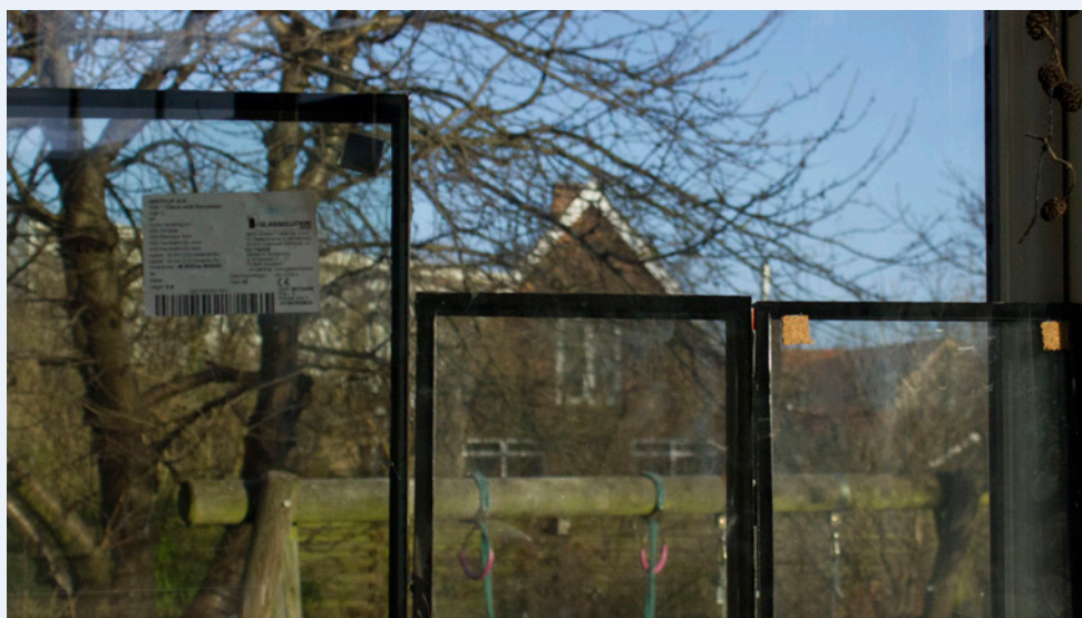
Fig 4. Rudetyper. 2-lags energirude med jernfattigt glas (th) og 3-lags standard energirude i midten. 3-lags energirude med jernfattigt glas som supplerende reference i laboratiormålinger (tv)
